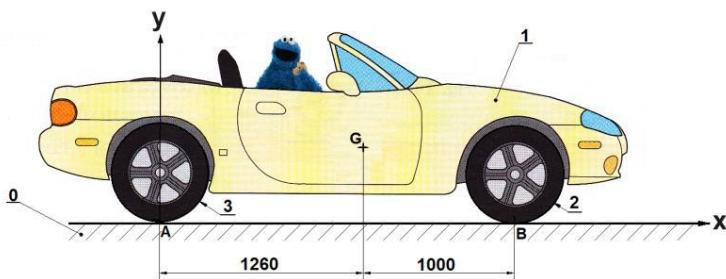
**Objectif :** déterminer les actions au niveau du contact entre les roues et le sol sachant que la masse du véhicule est égale à 1 079 Kg.
